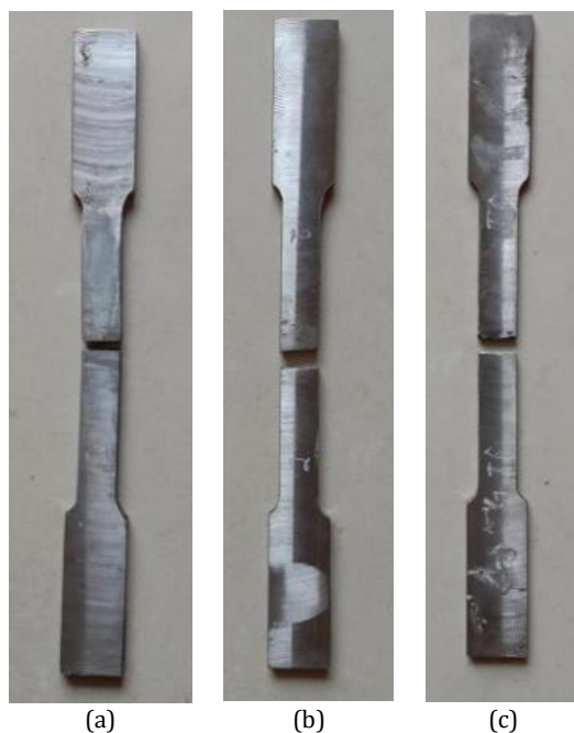
Gambar 6. Hasil uji Tarik tanpa Gas Argon, a). Spesimen 1, b). Spesimen 2, c). Spesimen 3
