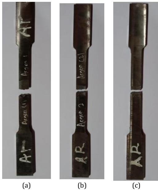
Gambar 6. Hasil uji Tarik Las menggunakan gas argon, a). Spesimen 1, b). Spesimen 2, c). Spesimen 3
