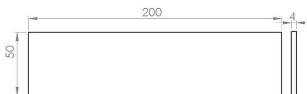
Gambar 2. Ukuran Bahan Spesimen Uji Tarik
